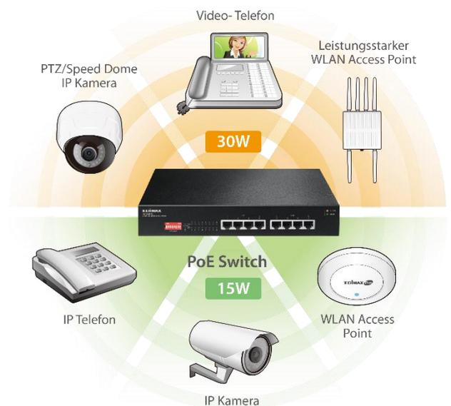
\*IP-Telefon: 3 - 7W, IP-Kamera: 7 - 10W, PZT-Kamera: 15 - 25+ W
